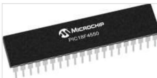
Fig. 5. Microcontrolador PIC18F4550
