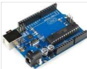
Fig. 1. Microcontrolador Arduino UNO
