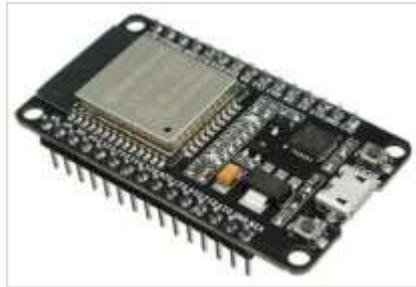
Fig. 3. Microcontrolador ESP32
