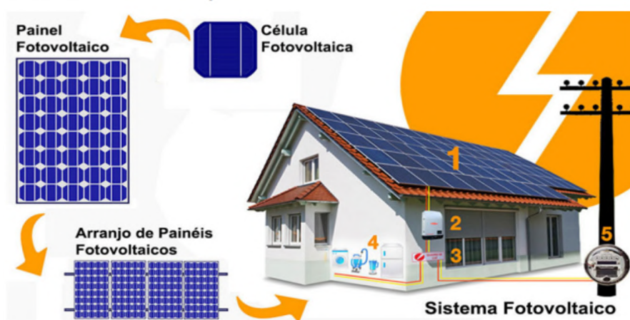
Figura 4 – Representação de sistema Fotovoltaico ON-Grid .
