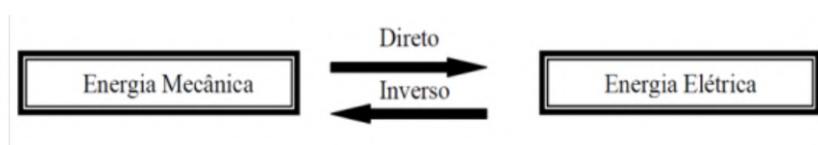
Figura 1 – Representação esquemática do efeito piezoelétrico.
