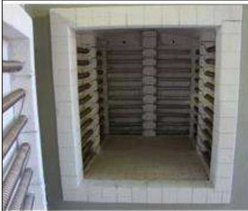
Figura 21 - Forno mufla utilizado para degradação térmica.
