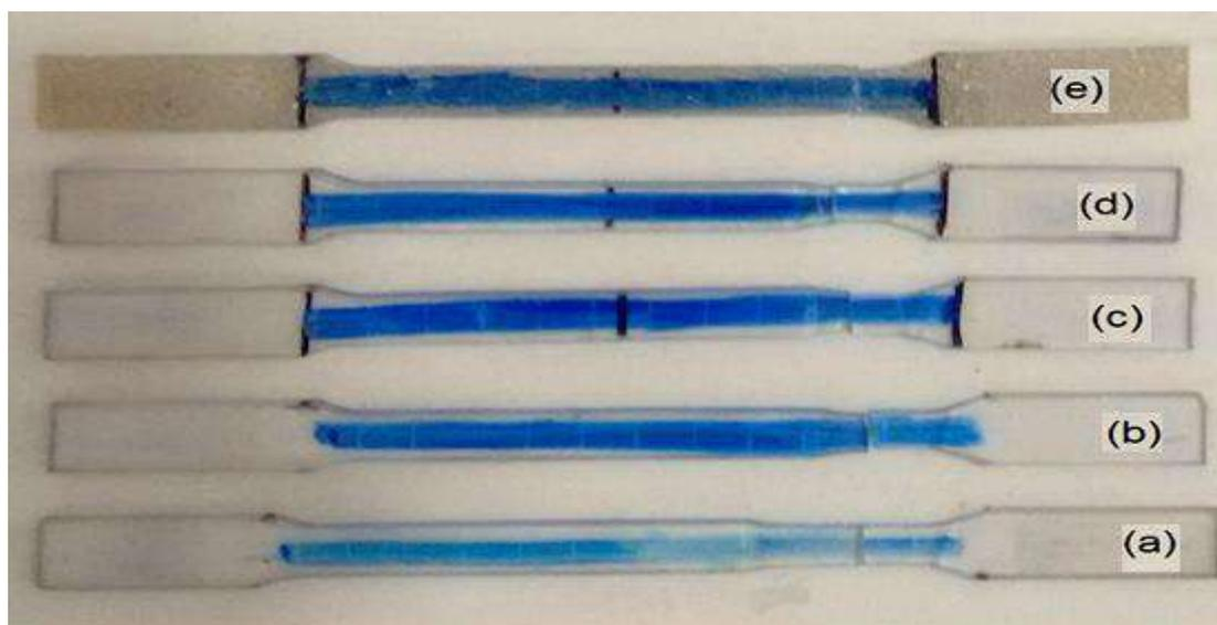
Figura 26 - Figura dos corpos de prova após os ensaios (a) Corpo de prova degradado a 200°C, (b) Corpo de prova degradado a 150°C), (c) Corpo de prova degradado a 100°C, (d) Corpo de prova degradado a 50°C e (e) CP como recebido.
