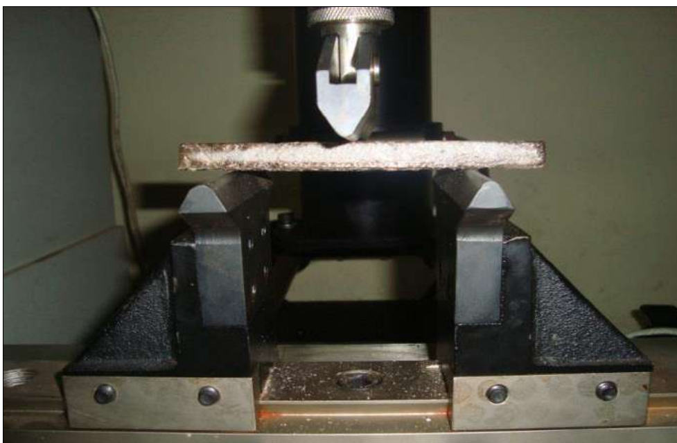
Figura 20 - Ensaio de resistência à flexão em três pontos.
