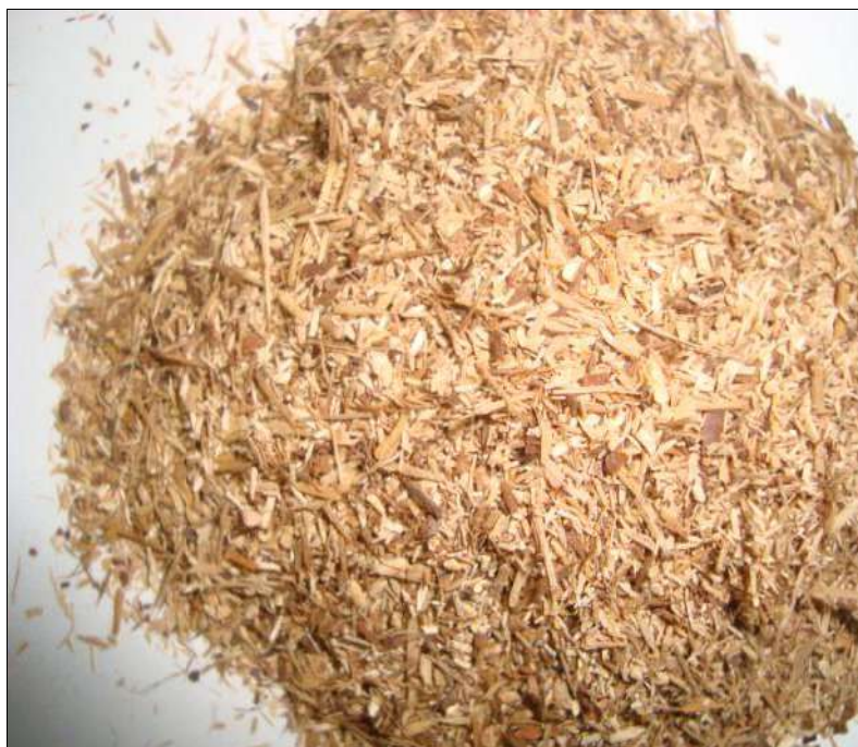
Figura 8 - Serragem de madeira após passar por moinho de facas.
