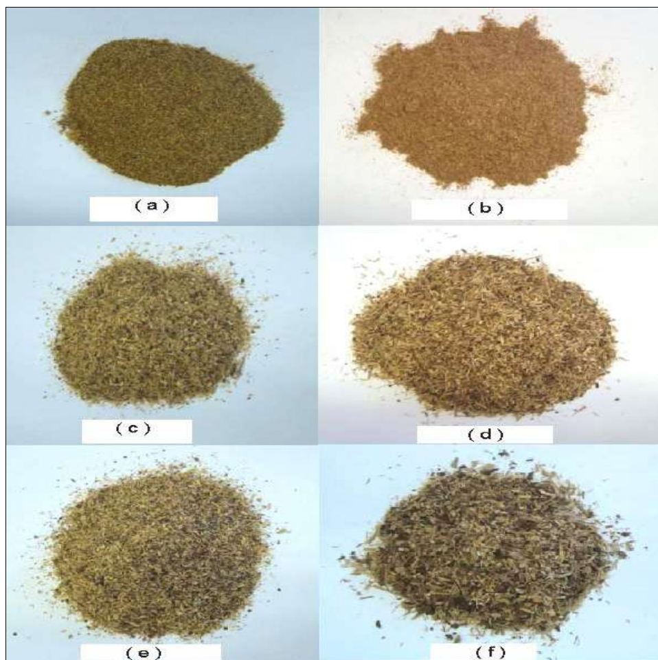
Figura 16 – a) Composição C – 35 – T, b) composição C – 35 – NT, c) composição C – 14 – T, d) composição C – 14 - NT, e) composição C – 8 – T, f) composição C – 8 – NT, g) Amostras de pó madeira tratada e não tratada.
