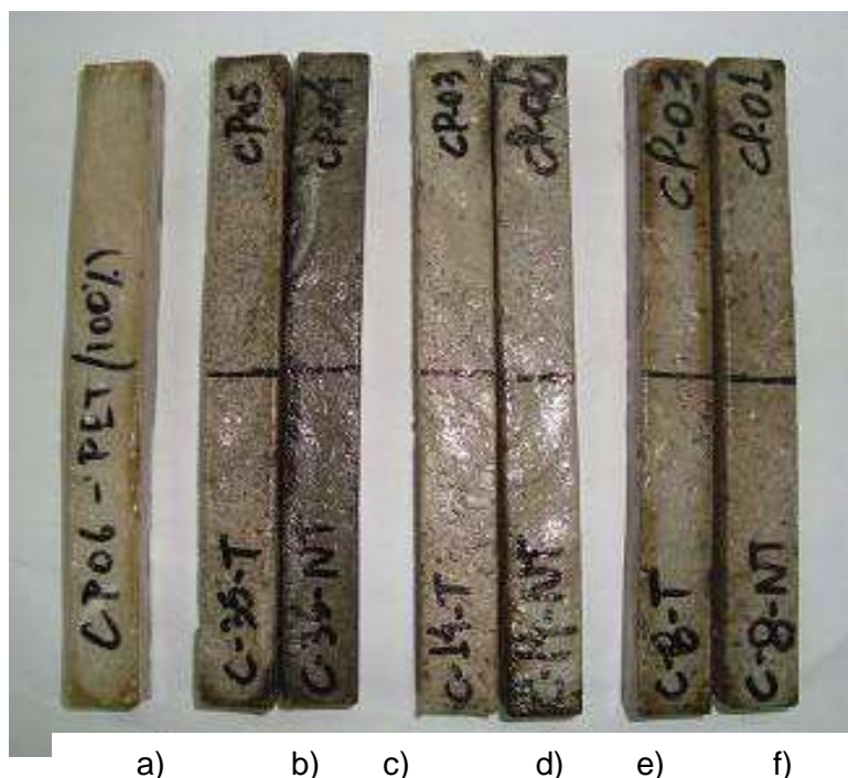
Figura 17 – CP's conformados, onde: a) é o CP de PET sem adição de resíduo, b) composição C-35-t, c) composição C-35-NT, d) composição C-14-T, e) composição C-14-NT, f) composição C-8-T e g) C-8-NT.
