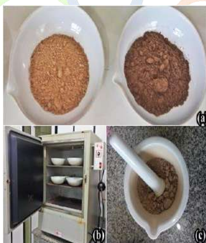
Figura 8. (a) Amostras em vasilhas de porcelana; (b) amostras na estufa; (c) amostra seca, sendo desagregada.
