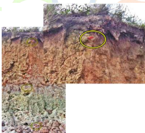
Figura 5. Seção 02/Ponto A2, ilustração da inserção dos pinos na margem do rio, permanecendo 10cm exposto.
