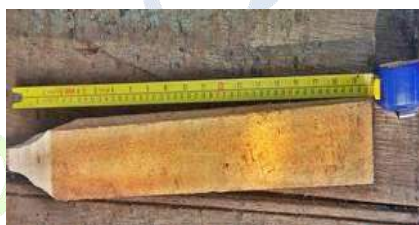
Figura 6. Ilustração da estaca utilizada para o monitoramento, possuindo 50cm de comprimento.
