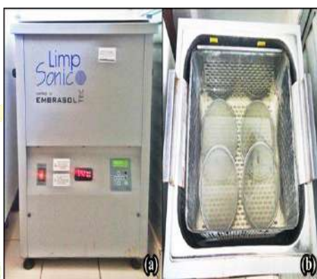
Figura 11. (a) lavadora LimpSonic; (b) as quatro peneiras utilizadas dentro da lavadora.
